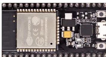
Rys. 3.1: Płytką ewaluacyjna z chipem ESP-WROOM-32
